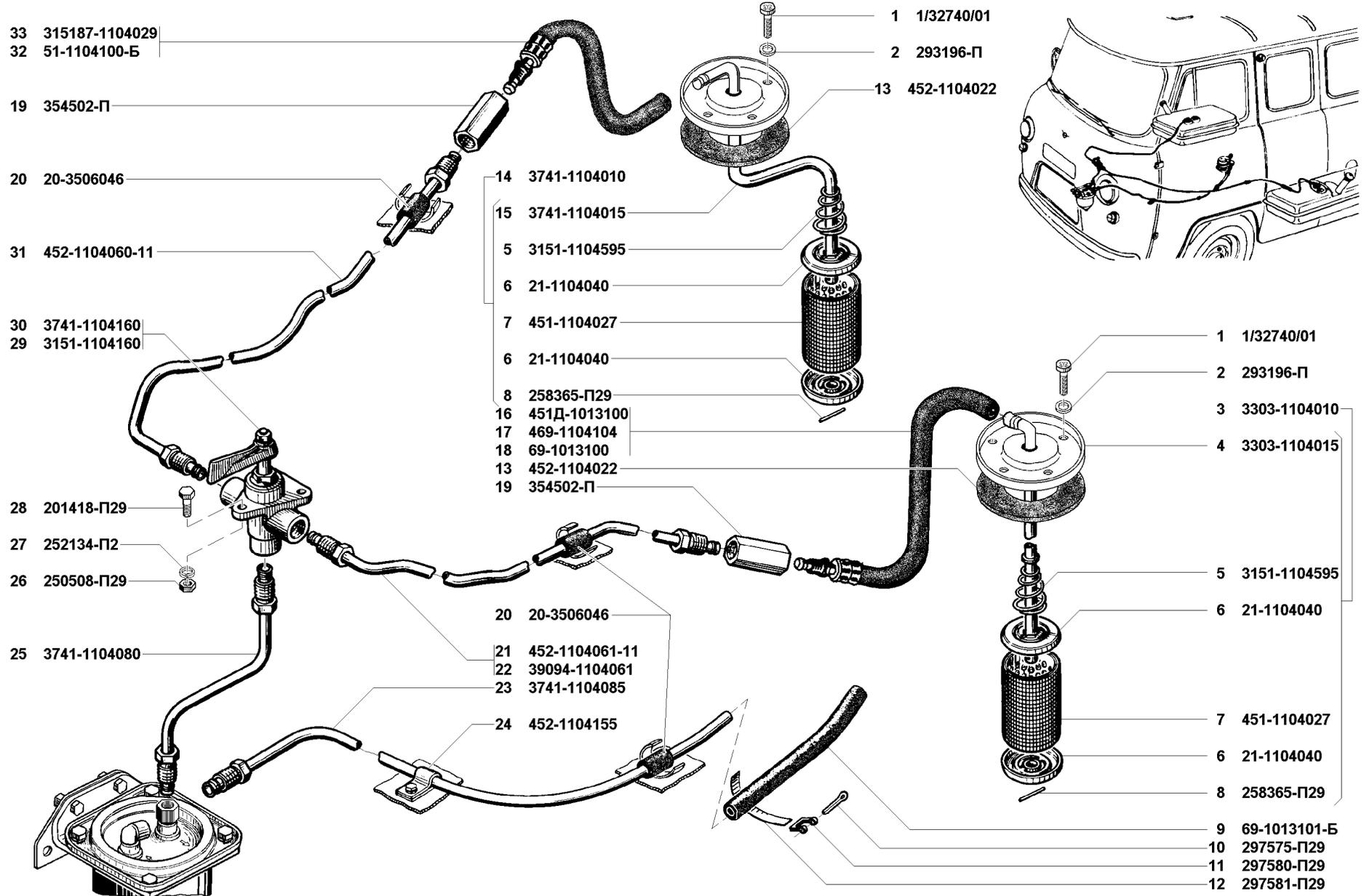
Рис. 18. Трубопроводы топливные (1104)
